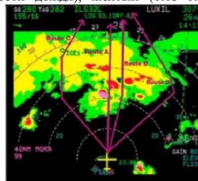
Рис.2 Индикация метеообстановки на навигационном дисплее самолета
