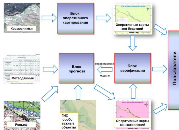
Рис. 1. Структурная схема аэрокосмического мониторинга паводков и наводнений
