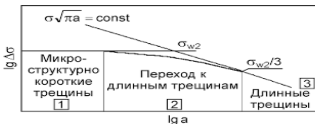
Рис.1. Диаграмма Китагава – Такахаша, указывающая, схематически области: 1-независимости; 2-слабой и 3-сильной зависимости «предела усталости» (ступенчатый брус, подвергающийся \sigma_{w2} от глубины трещины – a )
